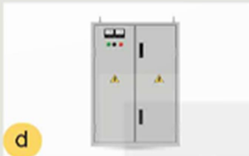
Tủ điện phân phối nhánh
