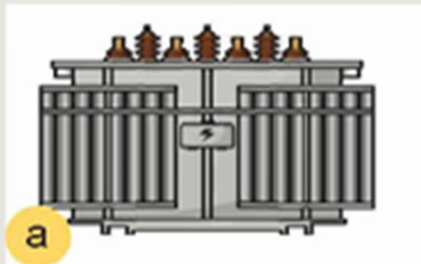
Máy hạ áp
