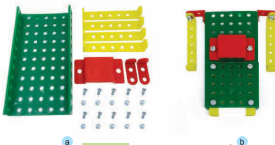
Hình 3 Thân robot và các chi tiết
