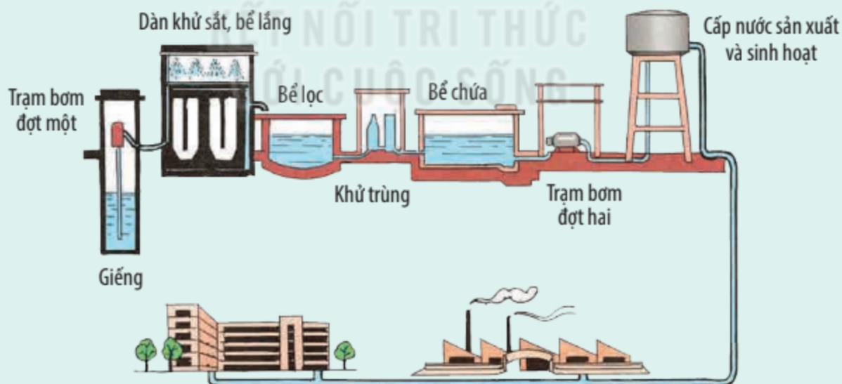
Hình 8. Sơ đồ dây chuyền sản xuất và cấp nước máy
