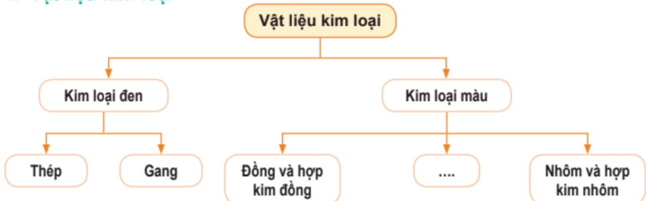
Hình 6.3. Sơ đồ phân loại vật liệu kim loại
