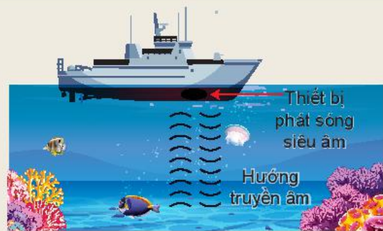
Hình 14.2 Ứng dụng sự phản xạ âm để xác định độ sâu của biển
