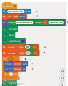
Hình 13.4. Chương trình điều khiển nhân vật đi chuyển theo hình có số cạnh được nhập vào từ bàn phím
