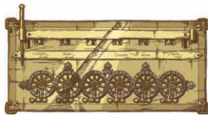
Hình 1.2. Chiếc máy tính cơ khí đầu tiên Pascaline
