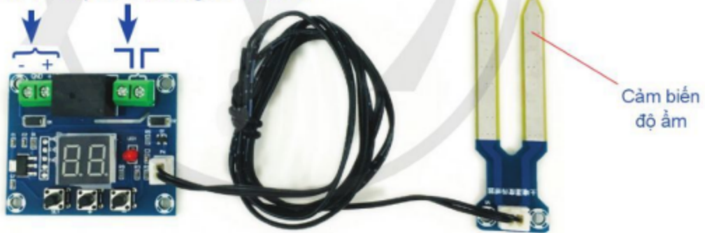
Hình 14.6. Sơ đồ chân đầu nối của mô đun cảm biến độ ẩm của đất
