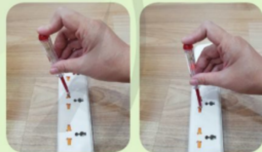
Hình 11.4. Dùng bút thử điện để kiểm tra ổ cắm điện
